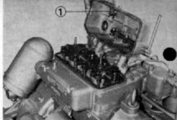
Afb. 11 Filter voor carterontluchting
