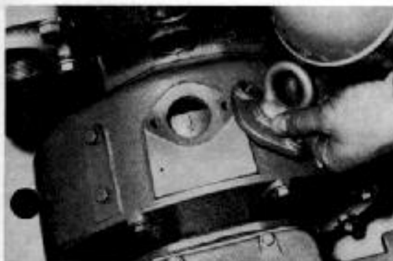
Afb. 18 Inspuithoek en bovenste dode punt zijn op het vliegwiel aangemerkt. Als het deksel wordt weggenomen worden deze merktekens duidelijk zichtbaar.
